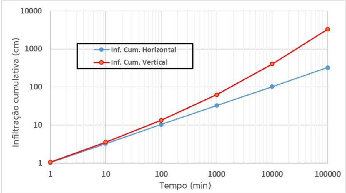
As curvas evidenciam que, para valores pequenos de tempo, as infiltrações horizontal e vertical são semelhantes; no entanto, para valores elevados de tempo, a infiltração vertical ultrapassa a infiltração horizontal substancialmente.
