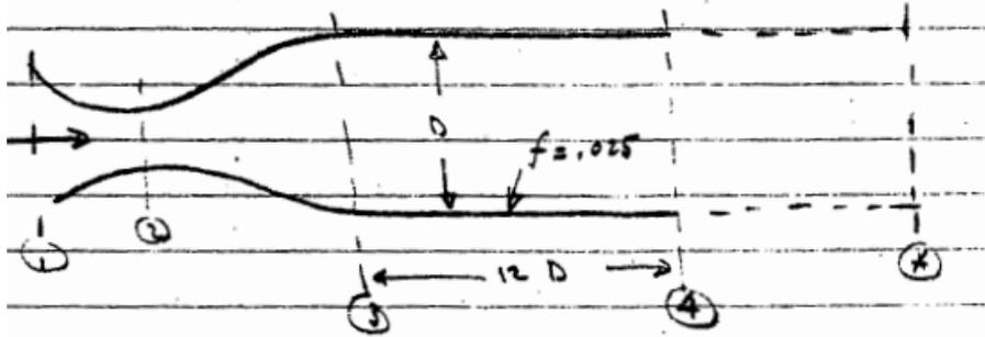
**Parte (a).ii:** Considere agora um sistema com choque na saída do bocal. Inserimos  $A_3/A_3^* = 3$  no webapp de escoamentos isentrópicos (não esqueça de especificar  $A_3/A_3^*$  (sup) para que o app retorne a solução supersônica) e extraímos  $M_3 = 2.6374$  e  $p_3/p_{o3} = 0.0473$ . Em seguida, entramos com  $M_3$  no webapp de choques normais e lemos o Mach a jusante do choque, que é  $M_4 = 0.5007$ ; temos também a razão de pressões  $p_4/p_3 = 7.9485$ .
