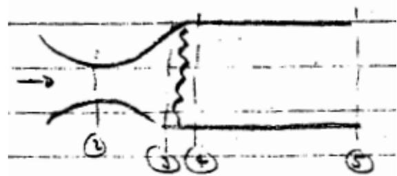
Prosseguindo, entramos com  $M_4$  na calculadora de escoamentos de Fanno e obtemos o parâmetro  $fL_{4\max}/D = 1.0634$  e a razão de pressões  $p_4/p^* = 2.1350$ . Para obter o comprimento de atrito da estação 5, escrevemos
